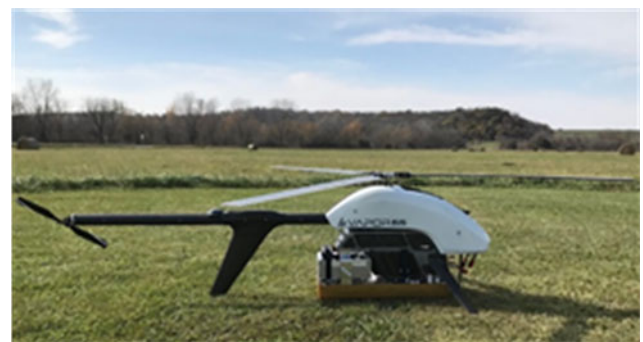
Fig. 13. UWB Snow Mini integrated on the Vapor 55 UAS helicopter.
