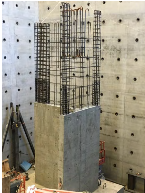
(d) Lift 2 steel cage
