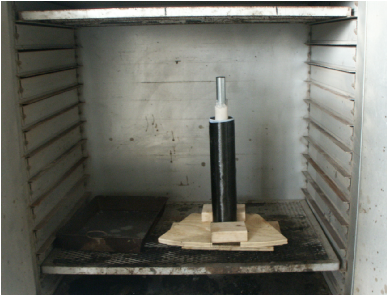
Fig. F1 - FRP Layer Curing in the Oven, Bar Type B.
